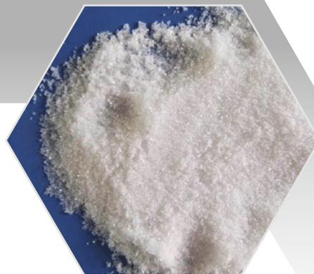
Хлорид лития используется в производстве компонентов, входящих в состав присадочных материалов сварочных электродов. Кроме того, хлорид лития входит в состав шихты модифицирующих флюсов в металлургии сплавов цветных металлов. Данное соединение лития используют также в фармакологии.
